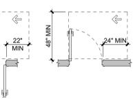
FIGURE 404.2.3.15 HINGE APPROACH, PUSH SIDE, W/ CLOSER AND LATCH
